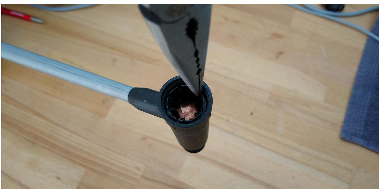
Jetzt kann man auch mit etwas Bastelei die beiden kleinen Kugellager für den Rotor ersetzen. An der Achse des Rotors befindet sich ein Magnet. Sie lässt sich daher einfach nach oben herausziehen. Dann von außen das innere Lager hochdrücken und mit der Distanzhülse herausnehmen. Anschließend das äußere Lager von innen nach unten drücken. Zusammenbau dann in umgekehrter Reihenfolge.
