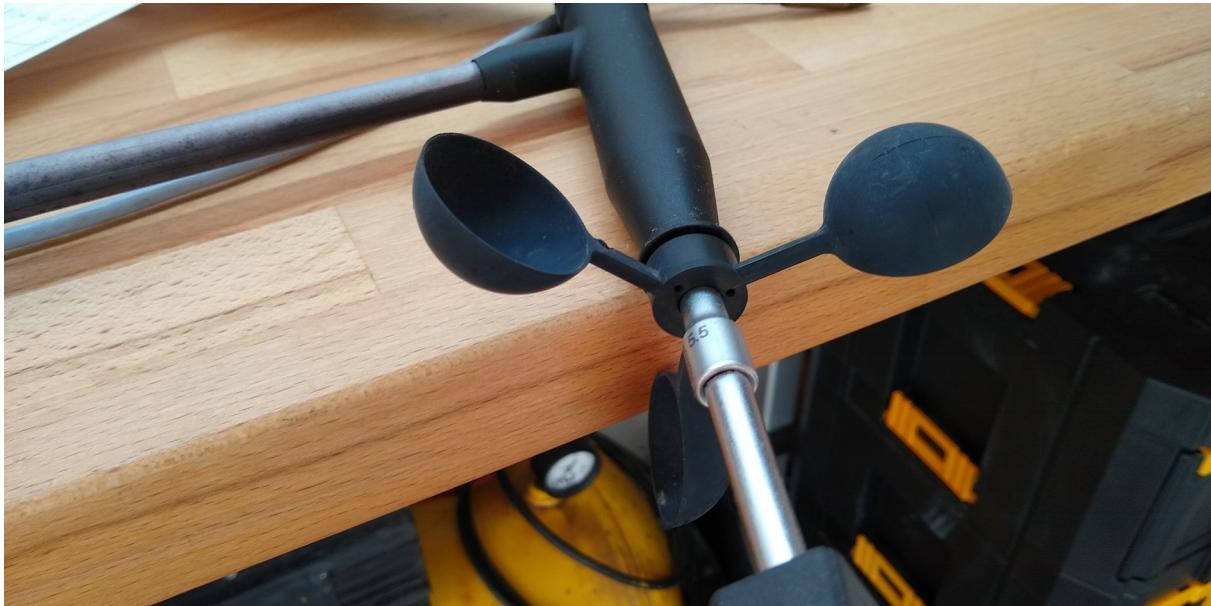
Dann die Schraube oben an der Windfahne entfernen und die Fahne nach oben abnehmen. Nun die Verschraubung mit einem 21er Maulschlüssel gefühlvoll abdrehen.
