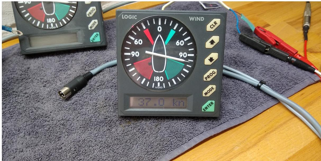
Natürlich bietet das System deutlich weniger Funktionen als moderne Windmesssysteme. Aber in vielen Fällen ist die Lösung vollkommen ausreichend, solange sie funktioniert. Daher hier ein paar Hinweise zur Fehlersuche. Bei einem Versuchsaufbau auf der Werkbank ist das relativ gut machbar. Ein Messadapter erleichtert dabei das abnehmen der entsprechenden Werte.
