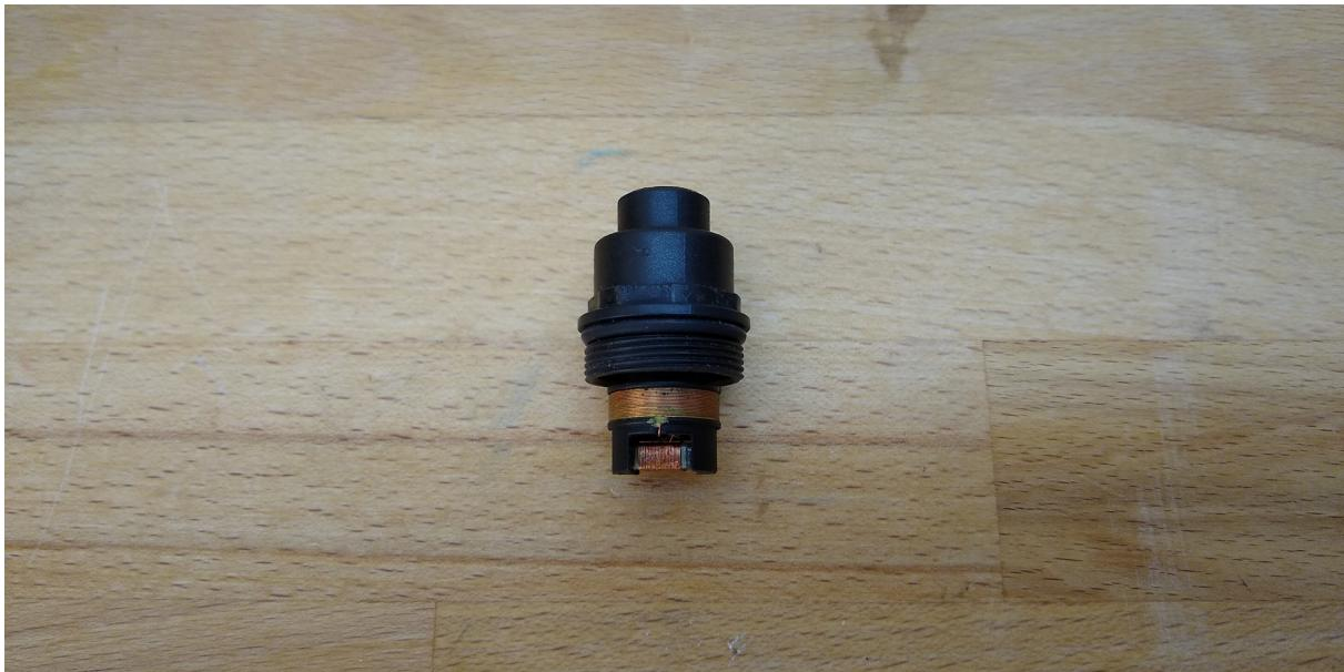
Es lässt sich mit etwas Vorsicht gut zerlegen. Ich nutze hierfür einen Schraubstock und passende Durchschläge. Alle Teile dann vorsichtig mit WD40 reinigen (nicht die Spule) und ggf. mit neuen Lagern wieder zusammensetzen. Ich spendiere dem Teil dann auch einen frischen O-Ring.
