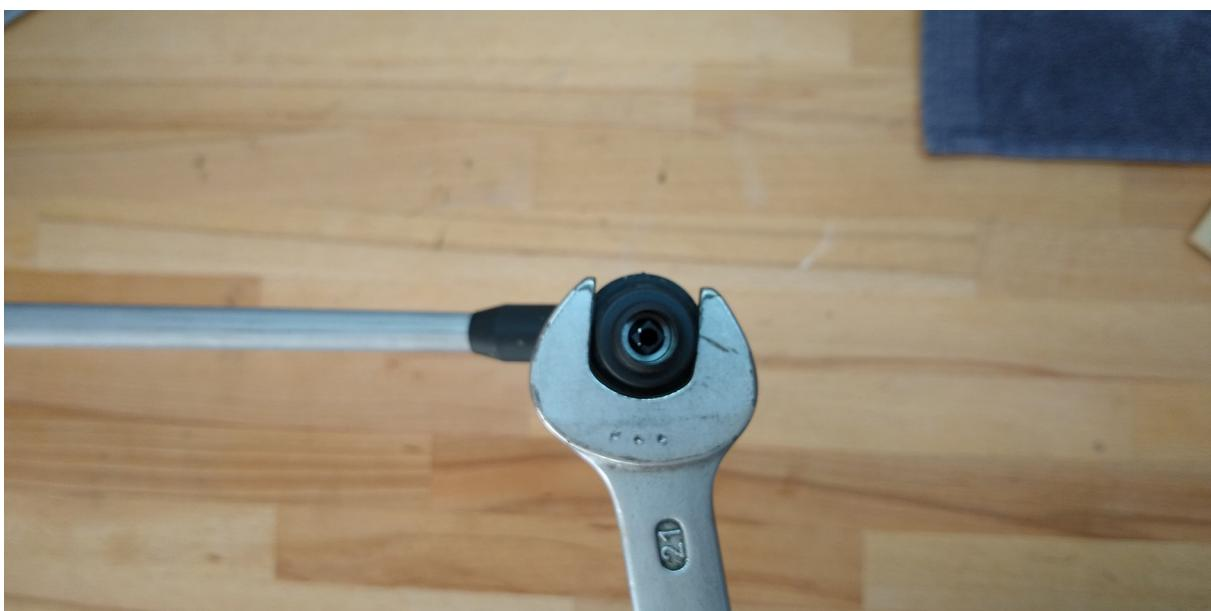
In diesem Teil befinden sich die beiden Kugellager für die Windrichtung.
